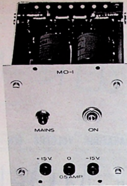
Het voedingsmoduul is kortsluitvast door stroombegrenzing.
