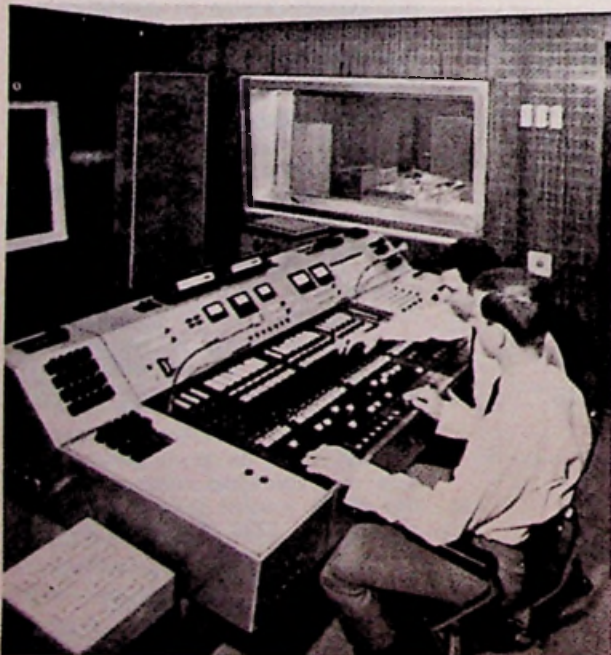
Compacte geluidsregietafel met de beide knoppenregisseurs
