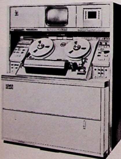
Nieuwe beeldmagnetoscoop TR70 van RCA, welke zowel in het 625/50 als 525/60-systeem leverbaar is en bij de WDR in West-Duitsland wordt gebruikt.
