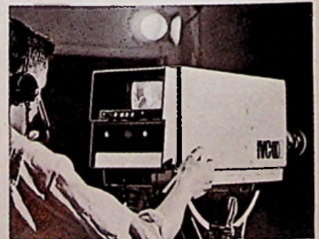
IVC-kleurencamera, type 121/101, uitgerust met 3 vidicons.
